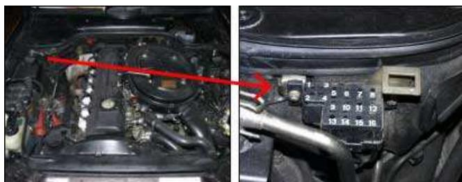
Mercedes E-класс W124 (1985-1995 гг.) Расположение: под капотом. С правой стороны по ходу движения. Закреплен на перегородке моторного отсека
