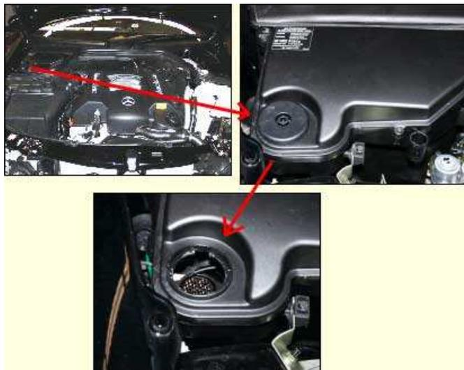
Mercedes C-класс W202 (1993-2001 гг.) Расположение: под капотом, с правой стороны по ходу движения. Разъем находится под круглой пластмассовой крышкой - для доступа к разъему снять крышку
