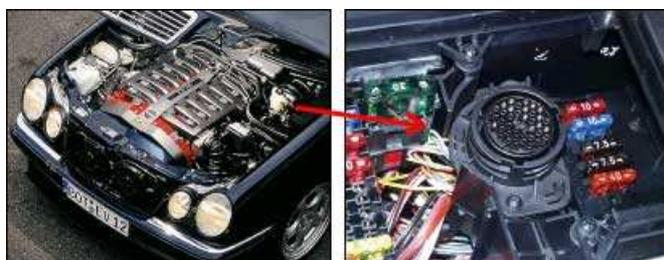
Mercedes E-класс W210 (1995-2003 гг.) Расположение: под капотом в блоке предохранителей. С левой стороны моторного отсека (по ходу движения). Для доступа снять крышку блока предохранителей
