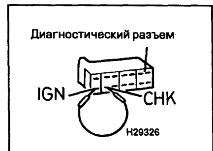
Рис. 24.3. Соедините перемычкой клеммы IGN и CHK диагностического разъема
