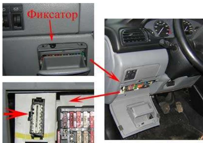
Peugeot 406 (1997 г.) Расположение: рядом с блоком предохранителей в торпедо (за маленьким отсеком для мелочей). Для доступа к разъему: открыть отсек для мелочей (в районе левого колена водителя), повернуть круглый пластмассовый фиксатор (лучше отверткой или большой монетой), открыть часть обшивки торпеды (крышку блока предохранителей, вместе с отсеком для мелочей). Разъем находится слева от предохранителей
