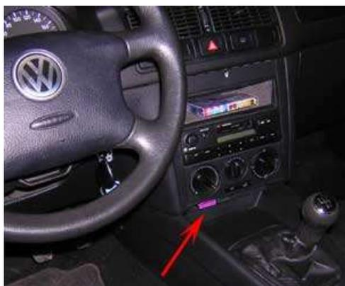
VolkswagenGolf (1998-2003 гг.)Расположение:внизу центральной консоли под пластмассовой заглушкой. Для доступа кразъему снять заглушку
