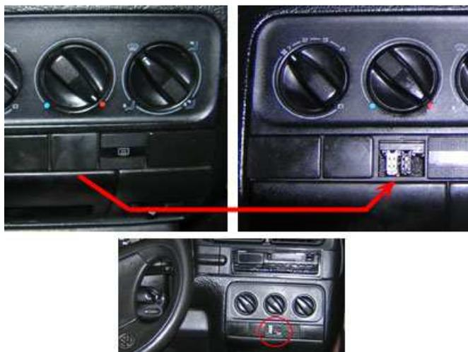
**VolkswagenGolf (1992-1993 гг.)** Расположение: в нише центральной консоли, под ручками управления отопителем (подручкой регулировки температуры), за заглушкой. Для доступа кразъемам вытащить заглушку (лучше подцепить сверху или снизу). Аналогично разъем расположен на VW Vento
