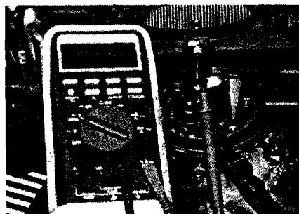
Рис. 4.11. Измерение сигнала датчика температуры воздуха (датчик расположен в корпусе воздухоочистителя)
