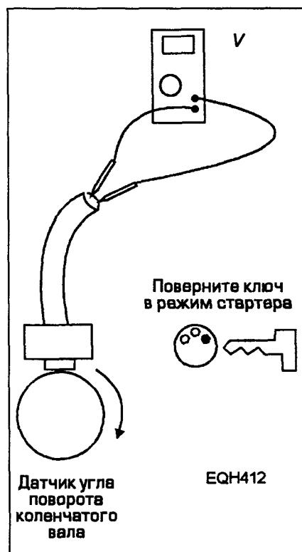
Рис. 4.3. Измерьте выходной сигнал датчика вольтметром в режиме постоянного тока
