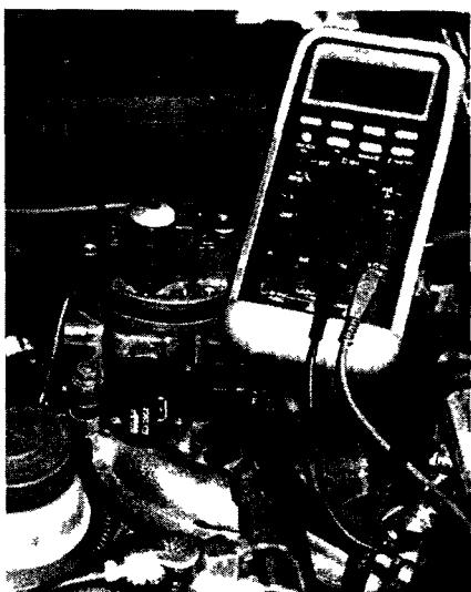
Рис. 4.21. Проверка потенциометрического датчика с помощью вольтметра. Здесь для подсоединения вольтметра к разъему использована скрепка для бумаги
