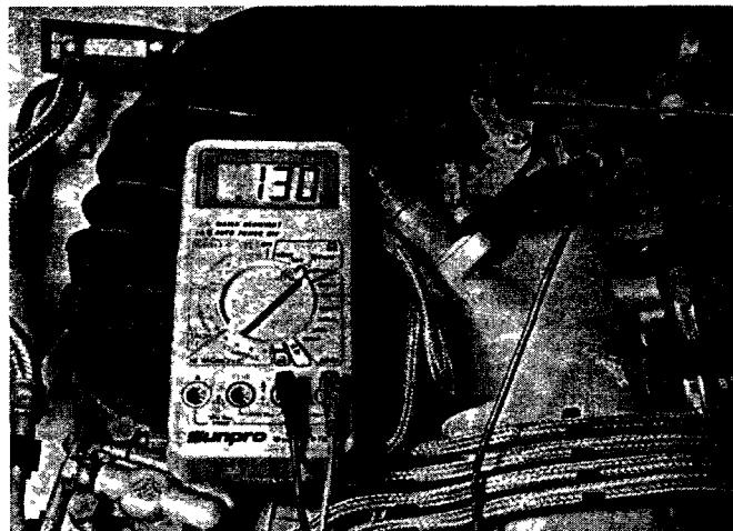
Рис. 4.33. Низкое напряжение срабатывания датчика кислорода (0.130 В или 130 мВ) означает бедную смесь
