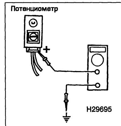
Рис. 4.13. Измерение напряжения сигнала потенциометра CO - обычное значение 2,5 В
